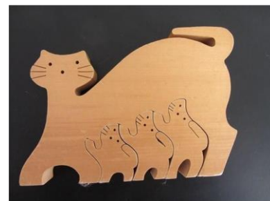
afb. 0.4 Ogen zijn boorgaten, snorharen zijn zaagsneden
